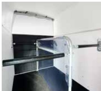
Agrandissement optique de l'espace grâce à un bat-flanc en PVC transparent coulissant vers la droite et vers la gauche à l'arrière pour l'embarquement
