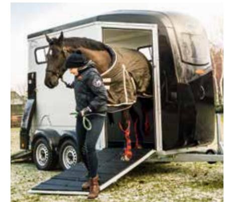
Pont avant de déchargement large et extra-long avec revêtement en caoutchouc et dispositif de levage à amortisseurs
