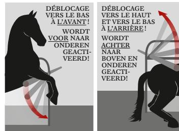
Sécurité accrue grâce aux barres de sécurité pouvant être débloquées à l'avant et à l'arrière (système anti-panique à l'avant et à l'arrière)
