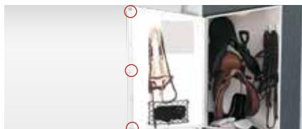
Selleerie pratique (de série sur Duo R) avec dispositif de verrouillage à 3 points; une clé universelle ferme toutes les portes et l'attelage en fonte
