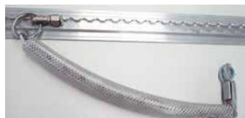
Fixation flexible grâce à un rail Airliner et des chaînes d'attache
