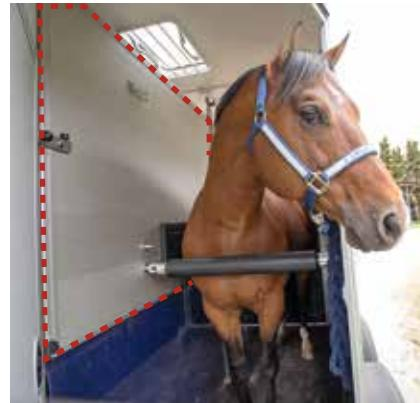
Transport sûr garanti par un bat flanc en aluminium à pilier central pivotant vers la droite et la gauche, avec séparation de tête intégrée (option)
