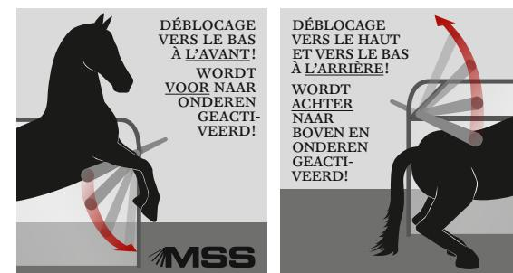
Système «MSS» (Multi Safe System\*\*) à barres de sécurité réglables en hauteur et en longueur à l'avant et à l'arrière
