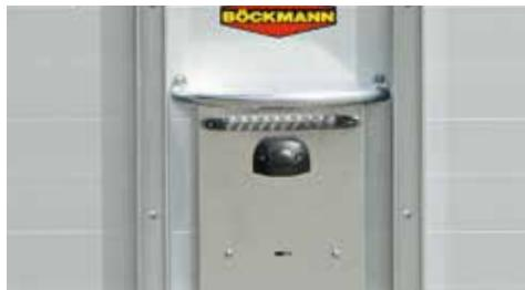
Une plus grande sécurité au cours de la circulation routière obtenue par un feu de freinage supplémentaire intégré au porte-plaque d'immatriculation
