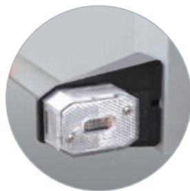
Markeringsverlichting voorzijde vanaf breedte 126 cm
