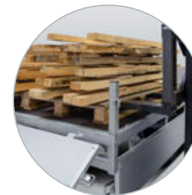
Borden openen tot onder de laadvloer. Schadevrij laden en lossen
