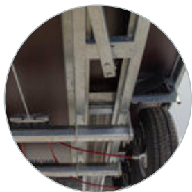
Sterk chassis met geïntegreerde rijplaathouders
