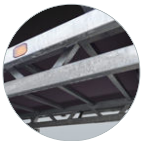
Robuust vakwerkchassis uit kokerprofielen
