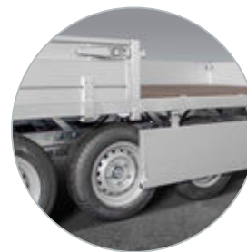
Gedeelde zijwanden vanaf 5 meter lengte
