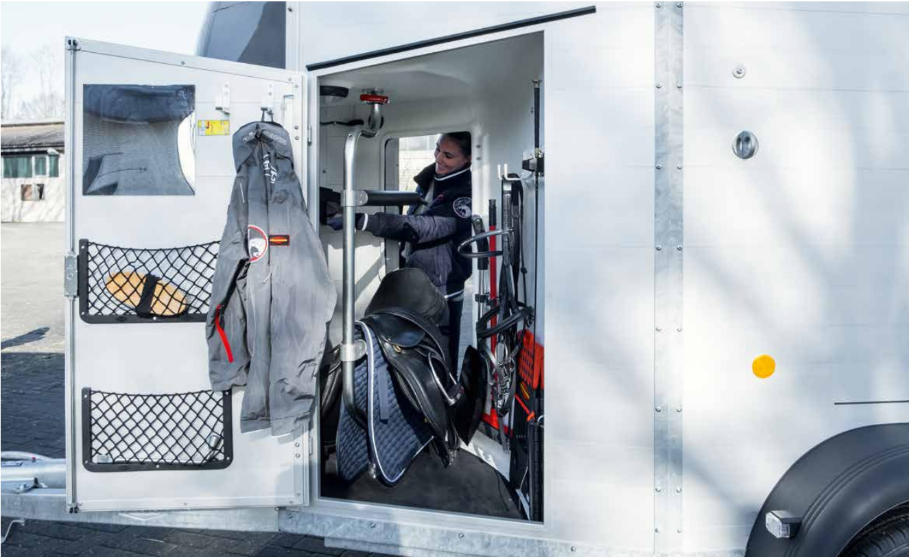
Comfortabele bediening en omvangrijke serie-uitvoering van de zadelkamer dankzij de deurstops en de telescoopbezem, kunststof schep, deurnet, spiegel, zweephouder, voerbak, grote trenshaken, pad-houder, ledverlichting en opklapkrukje met beveiliging (uitvoering afhankelijk van het model).
