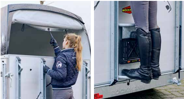
Eenvoudige bediening dankzij de praktische oprolfunctie van de zeillift. Hefinrichting voor het gemakkelijk openen van de achterklep, extra met stabiel opstapje met 2 treden.
