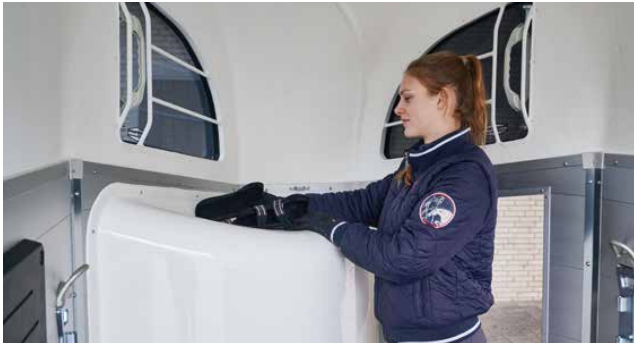
Zadelkamer als legvlak dankzij de geoptimaliseerde vorm met veel plaats en zonder bijtranden voor het paard. Praktische reiniging door een gedefinieerde waterafvoer.
