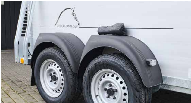
Spatschermen als legvlakken dankzij de brede en aan de bovenzijde rechte vorm van het slagvaste spatscherm uit kunststof of polyester (toebehoren).
