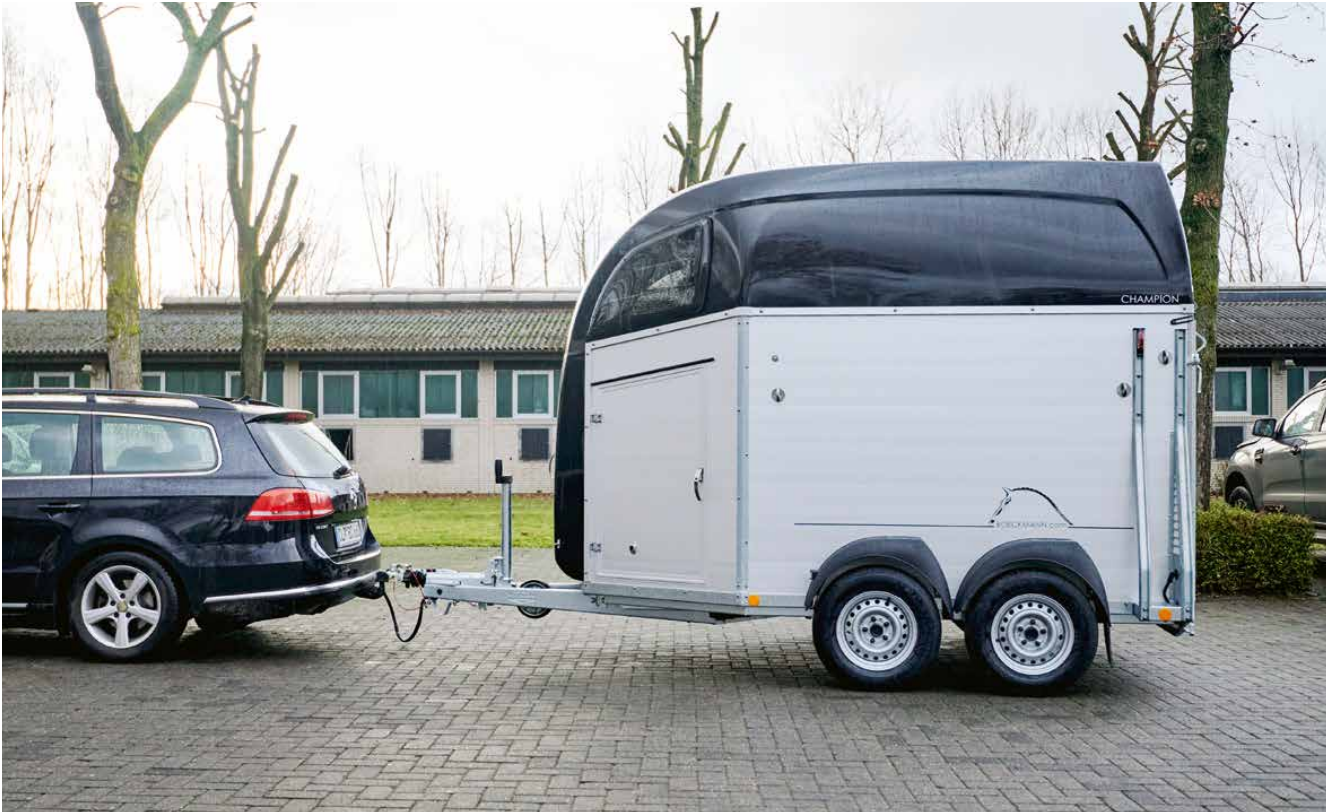
Licht te trekken dankzij de aerodynamische opbouw en het lage zwaartepunt.
