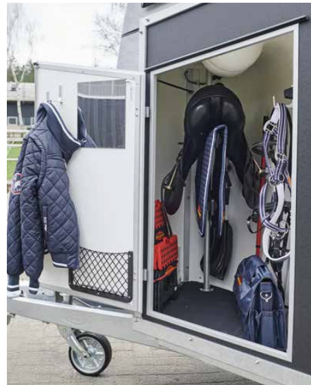
Alles gemakkelijk van buitenaf toegankelijk dankzij de grote zadelkamerdeur. Optimaal afsluiten dankzij de driepunts-vergrendeling en de rubberafdichting.
