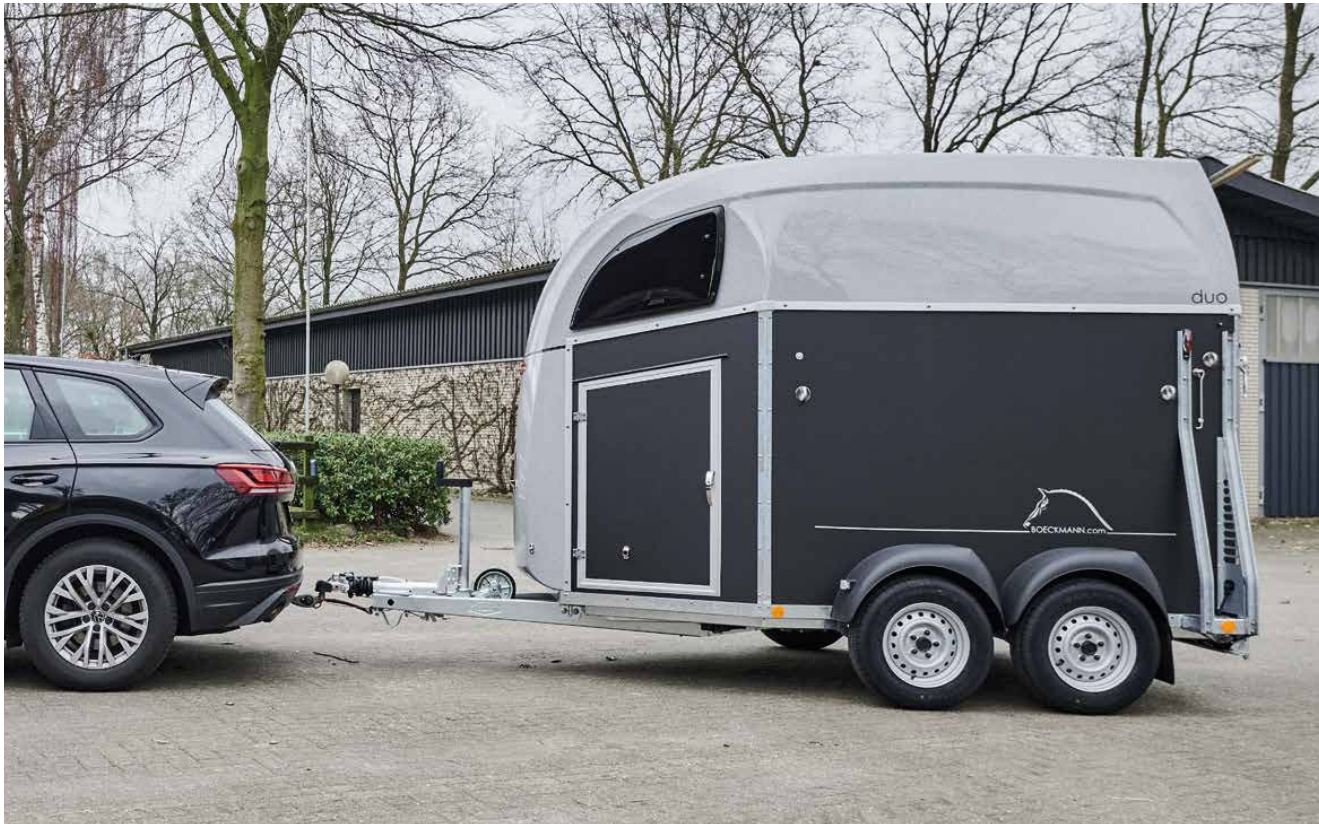
Licht te trekken dankzij de aerodynamische opbouw en het lage zwaartepunt.
