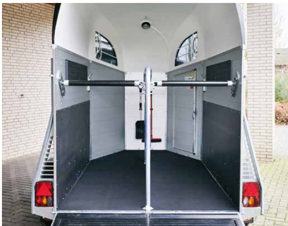
Champion C Comfortabel paardengedeelte met trapbescherming, bekleding aan de zijwand en MSS voor twee paarden. Grote instapdeur naar het paardengedeelte en optioneel van buiten toegankelijke zadelkamer.
