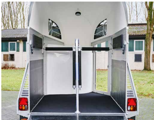
Champion R Aerodynamische opbouw dankzij de polyesterboeg met standaard zadelkamer. Comfortabel paardengedeelte met trapbescherming, bekleding aan de zijwand en MSS voor twee paarden.
