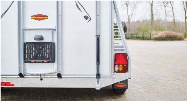
De paardenhoef kan niet doorglijden en u heeft goed zicht vanuit de auto dankzij de gesloten achtersteunen met speciale perforatie.
