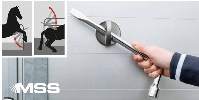
Snelle veiligheid bij een noodgeval dankzij het bewezen Multi Safe-veiligheids-boxstangen-panieksysteem (MSS) voor en achter. De wielsleutel maakt deel uit van de serie-uitvoering. Bij de Champion Uno: veiligheids-boxstangensysteem met bekleding met kettingen (in hoogte en in lengte verstelbaar).
