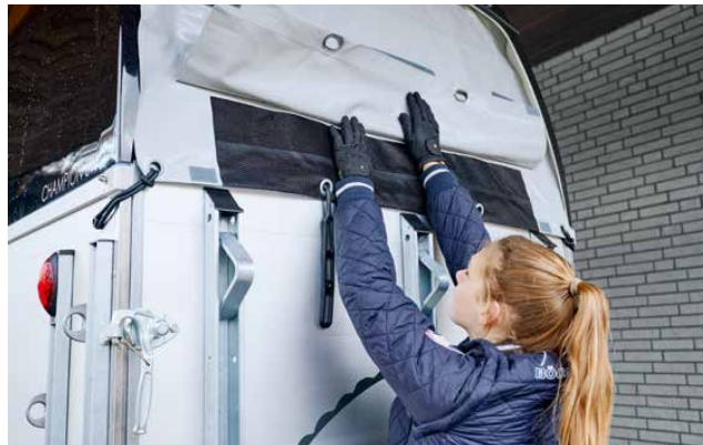
Zeillift met geïntegreerd net en automatische oprolfunctie.
