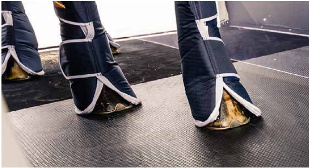
Veilig staan door de rubbervloer met antislip textielstructuur (slijtmat is toebehoren).
